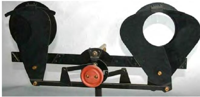
Abb.15: Dissolver an „Magic Lantern“ zur Überblendung, aus: An Expert „The Art of projection and complete magic lantern manual“ 1893, fig.12 p.15
